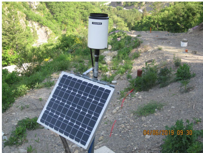
Coffret de la centrale d'acquisition avec panneau solaire et pluviomètre
