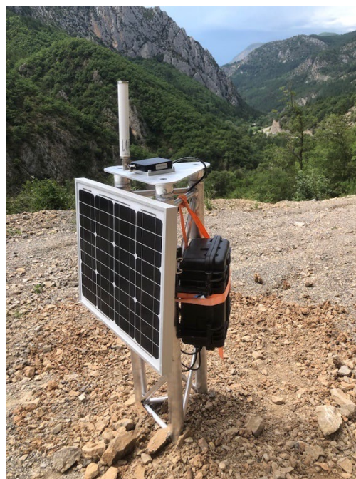
Géocube sur la structure et dispositif d'alimentation autonome
